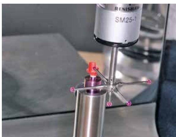
Abb. 4: Taktiles Abtasten eines manuell modellierten Testabutments aus Pattern Resin (GC Europe, Bad Homburg) für die maschinelle Herstellung aus Zirkoniumdioxid.
